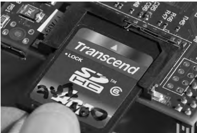
Abb. 1.11: Achten Sie beim Einstecken der SD-Karte darauf, dass sie nicht verkantet, damit der Kunststoffrahmen, der die Karte hält, nicht beschädigt wird.
